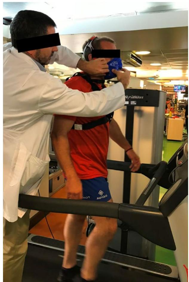
Figura 2: Atleta realizando prueba de consumo máximo de oxígeno (VO<sub>2</sub> máx.) y la velocidad máxima de VO<sub>2</sub> máx. (Vel. VO<sub>2</sub> máx.) en trotadora. Supervisado y registrado por un médico deportólogo.
