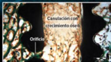
Plano transversal del ancla SwiveLock BioComposite con orificios: ocho semanas tras la implantación en un modelo canino que muestra crecimiento óseo en los orificios y la canulación central<sup>1</sup>
