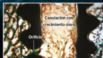
Plano transversal del ancla Swivelock BioComposite con orificios: ocho semanas tras la implantación en un modelo canino que muestra crecimiento óseo en los orificios y la canulación central<sup>1</sup>
